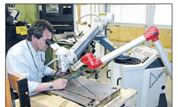
Mit dem mobilen Laserschweißen kommen die Experten von SR-Erodierertechnik direkt zum Kunden.
