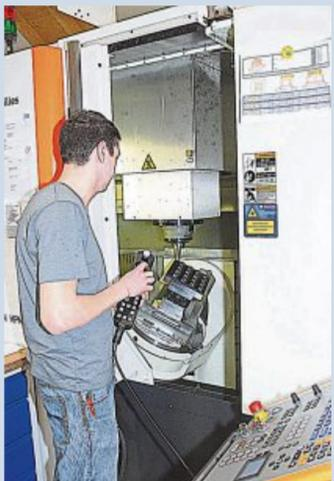
● Das neue 5-Achs-Bearbeitungszentrum beim Fräsen von Formteilen für ein Spritzgusswerkzeug
